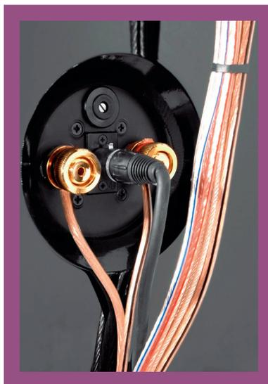
Le toron de câbles s'échappant d'une enceinte Tonnara frôle les 25 mm<sup>2</sup> de section... Ici, détail du bornier des caissons de grave avec le connecteur central dédié aux signaux d'asservissement. Ci-dessous, le processeur Tonnara d'asservissement conçu par Alain Journet. Mini-taille, mini-réglages mais il fait un maximum !
